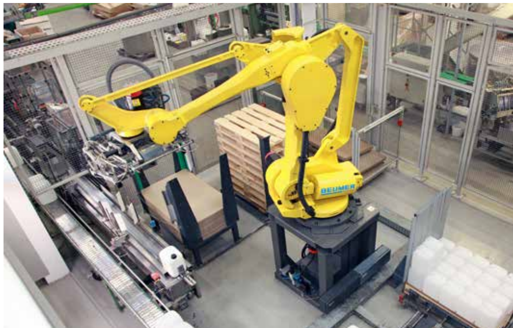
BEUMER robotpac ermöglicht die zuverlässige, sichere und automatisierte Palettierung von Säcken, Kartons, Eimern und Kanistern
