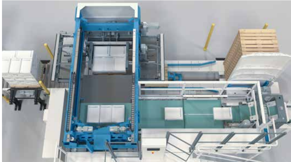
BEUMER paletpac-Systeme bieten besonders hohe Stapelqualität und Zuverlässigkeit beim Palettieren von Produkten auf Paletten Bilder: BEUMER Group GmbH & Co. KG
