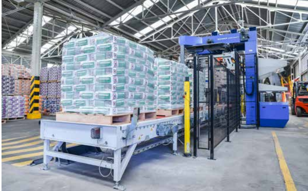
BEUMER stretch hood A bietet höchste Ladungsstabilität durch die Kombination von vertikalen und horizontalen Rückstellkräften der Folie
