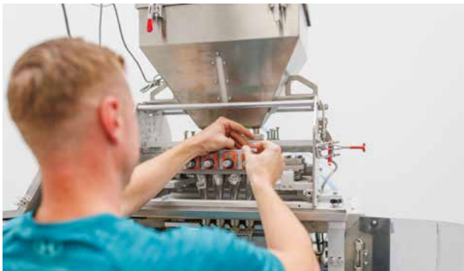
Präzises Justieren der Anlage für TROcarbon®-Beutelketten: Die unterbrechungsfreie maschinelle Zuführung sichert maximale Effizienz im Verpackungsprozess
