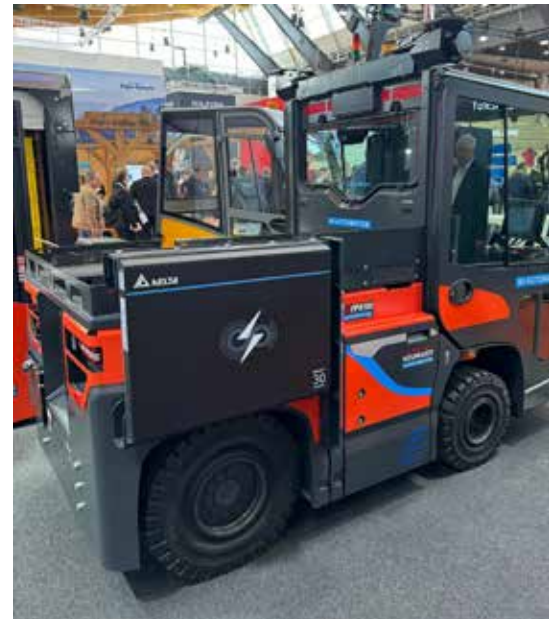
Moovair 30: Delta's MOOVair 30 - ein 30-kW-Wireless-Charging-System für den 80-Volt-Betrieb Bild: DELTA
