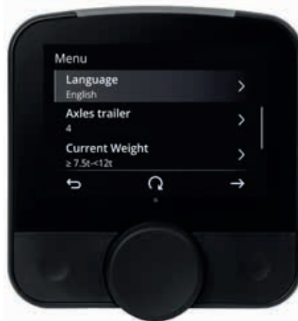
Die wichtigsten Menüpunkte lassen sich direkt mit dem Drehknopf und den beiden seitlich angeordneten Drucktastern einstellen
