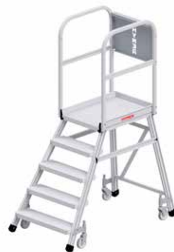
Die fahrbare Podesttreppe R13 ist einseitig begehbar und bietet mit ihrer zertifizierten Rutschhemmung höchste Sicherheit – auch auf öligen Böden. Die grosszügige Arbeitsfläche, das dreiseitige Geländer sowie die individuell einstellbaren Federrollen sorgen für ergonomisches und flexibles Arbeiten.
