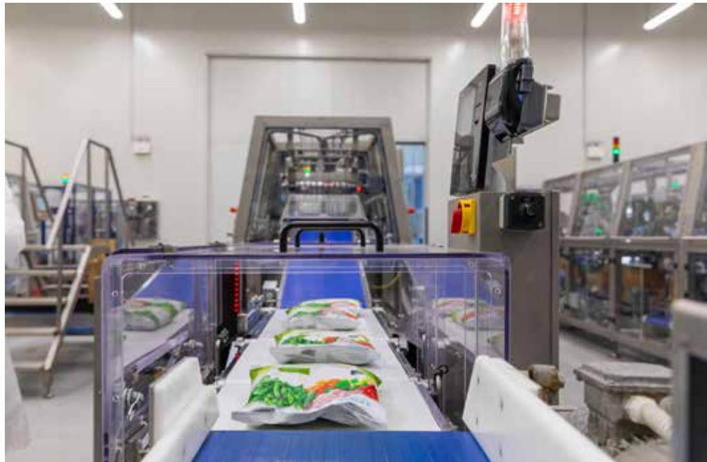
Bilder 1–6: Gesamtansicht der hochautomatisierten Produktions- und Verpackungsanlagen von Barba Stathis in Griechenland. Die Mehrkopf- und Kontrollwaagen von Ishida sorgen in allen Linien rund um die Uhr für präzise Verpackungsgewichte, maximale Effizienz und gleichbleibend hohe Produktqualität. Bilder: Barba Stathis / Ishida
