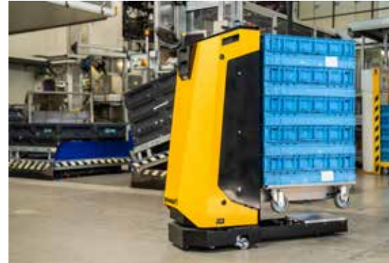
Die Basisversion des NXS 300 in Aktion: Der ultrakompakte AMR ist für Kleinladungsträger (600 x 400 mm) optimiert und navigiert dank omnidirektionalem Antrieb und 360-Grad-Sensorik sicher durch enge Gänge Bild Continental
