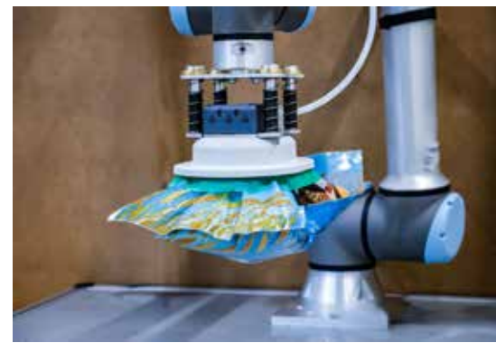
Selbst unvollständig befüllte Papier-, Kunststoff- und Gewebesäcke nimmt der Sackgreifer PSSG-X sicher auf
