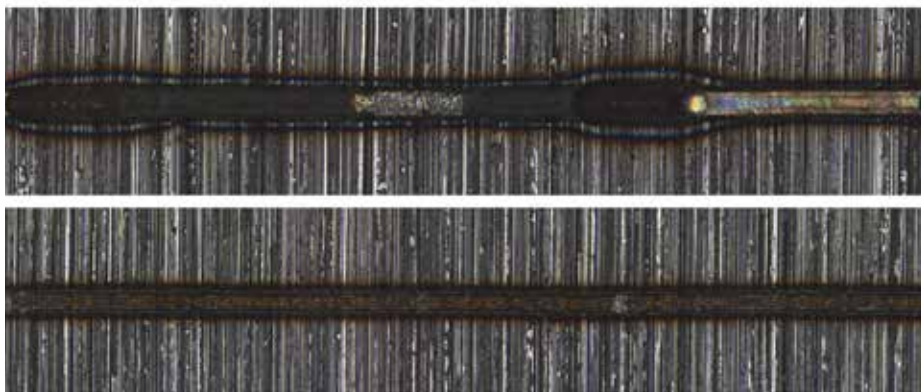
Avant-après : en haut, une soudure laser avant «apprentissage», en bas, une soudure issue du processus optimisé par l'algorithme Image: Empa
