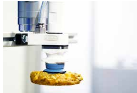
Der Strömungsgreifer SFG im Hygienic Design wartet mit einer hohen Saugleistung auf und überzeugt in hochdynamischen Prozessen
