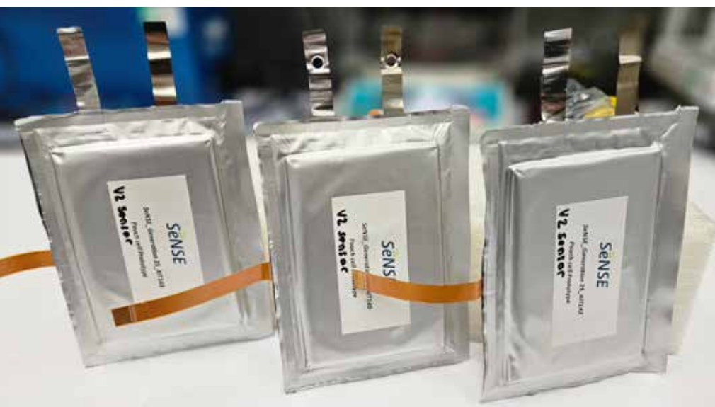
Les nouvelles cellules lithium-ion sont plus durables, plus sûres et ont une densité énergétique plus élevée Image : Consortium SeNSE
