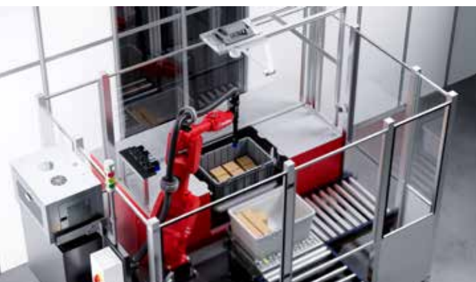
CarouselAI ist das erste KI- und robotergestützte Einzelstückkommissioniersystem von AutoStore
