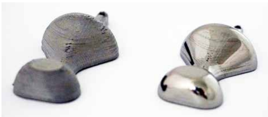
Beispiel für 3D-gedrucktes Werkstück, vor (li) und nach der Bearbeitung (re). Bild: OTEC
