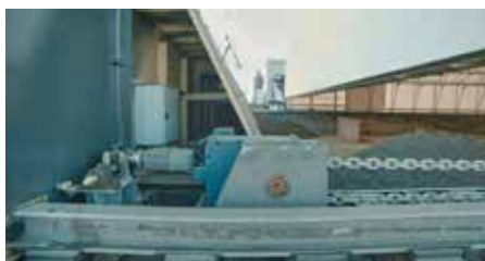
Das Antriebssystem Tecdos-Pi-Gamma arbeitet mit einer Kraft von 140 Kilonewton. So trotzt es selbst starken Windlasten. Bild: RUD
