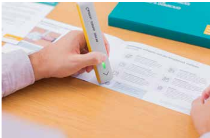
Der neue Bestellstift der Post scannt den Bestellcode und übermittelt die Bestellung per LoRaWAN an die Post. Bild: Schweizerische Post
