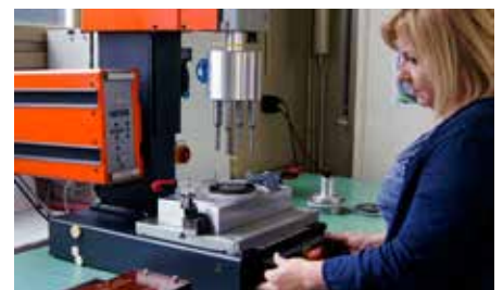
Nachbearbeitung, hier Ultraschallschweissen. Bild: Brac
