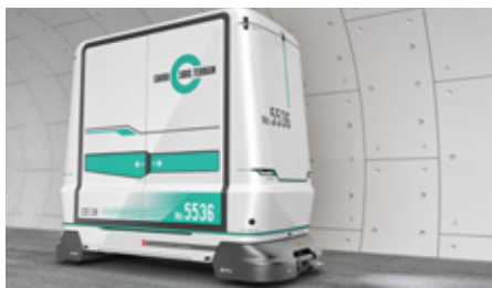
Im CST-Tunnel werden alle Warentransporte vollautomatisch mit autonomen Shuttles abgewickelt. Bild: CST
