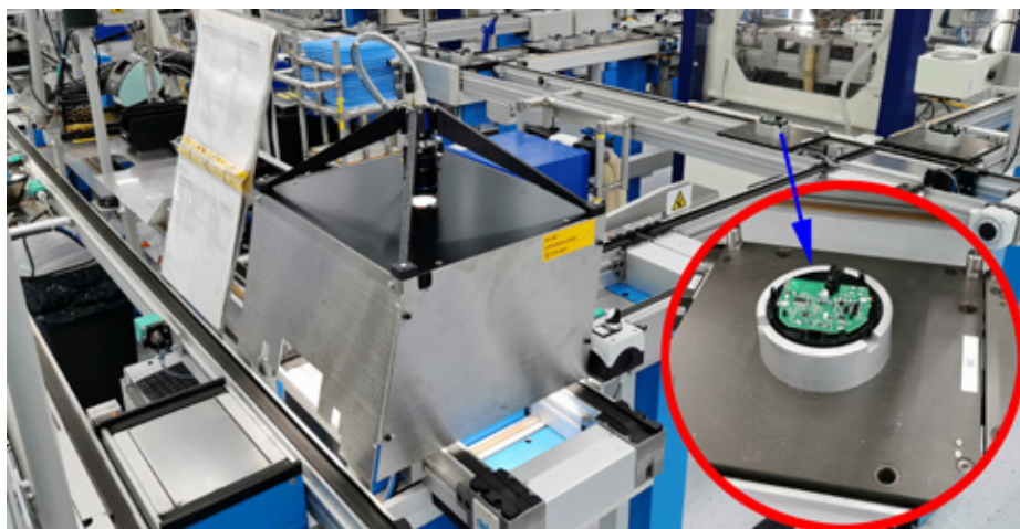
Voll integrierte 100%-ige optische Qualitätskontrolle von Lötstellen mittels Deep Learning Verfahren auf einer Produktionsstrasse von Rauchmeldern. Bild: Siemens Smart Infrastructure
