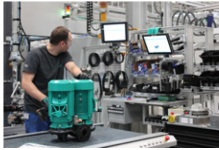
Die Software flexAssistant ersetzt die papiergebundene Anleitung und Dokumentation mit einer digitalen Montageführung: Der Bediener erhält über einen Monitor alle relevanten Informationen über das aktuelle Bauteil sowie die notwendigen Arbeitsschritte, die an diesem Montageplatz vorgenommen werden sollen. Bilder: WILO SE
