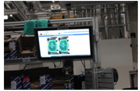
Die Software flexAssistant ersetzt die papiergebundene Anleitung und Dokumentation mit einer digitalen Montageführung: Der Bediener erhält über einen Monitor alle relevanten Informationen über das aktuelle Bauteil sowie die notwendigen Arbeitsschritte, die an diesem Montageplatz vorgenommen werden sollen. Bilder: WILO SE
