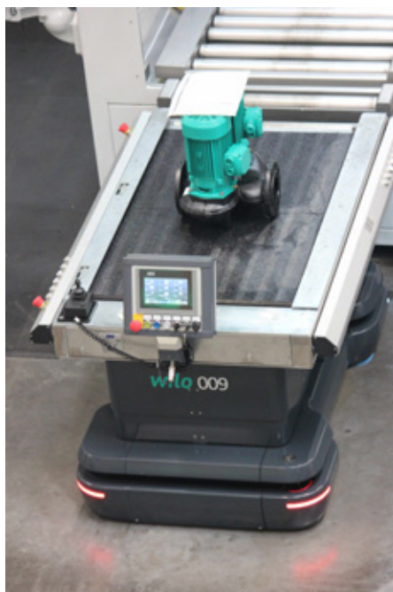
Dank intelligent vernetzter, fahrerloser Transportsysteme kann jede Montagestation frei angefahren werden, wobei selbst Überholvorgänge möglich sind. Das System verhindert dabei automatisch den Weitertransport etwa bei Nichterfüllung bestimmter Kriterien oder sorgt für eine Umleitung zur Analyse. Bild: WILO SE
