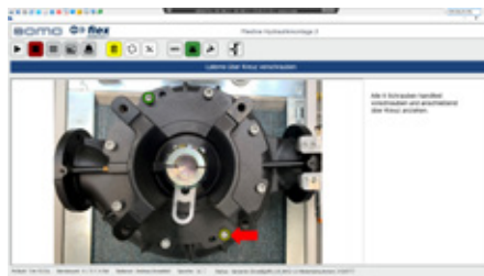
Die Werkerführung unterstützt die Montage durch eine virtuelle Schritt-für-Schritt-Anleitung, in der beispielsweise das zu benutzende Werkzeug und die entsprechende Schraubenposition gezeigt werden. Bilder: WILO SE
