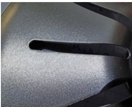
Gratfrei, fleckenfrei und seidenglatt ge- strahlt: Typische Anforderungen an metallische Komponenten für die industrielle Ferti- gung. Bild: Klaus Vollrath
