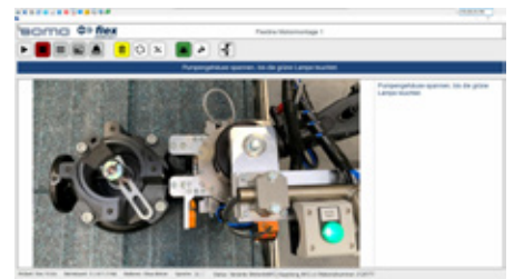
Die Werkerführung unterstützt die Montage durch eine virtuelle Schritt-für-Schritt-Anleitung, in der beispielsweise das zu benutzende Werkzeug und die entsprechende Schraubenposition gezeigt werden. Bilder: WILO SE
