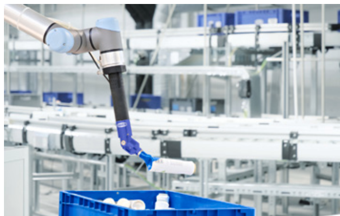
Den Bin-Picker SBPG liefert Schmalz anschlussfertig und mit integrierter Vakuum-Erzeugung.
