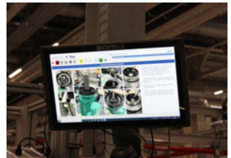
Das System übermittelt automatisch Arbeitsanweisungen oder den Status eines AGVs an die entsprechenden Montageplätze. Bilder: WILO SE
