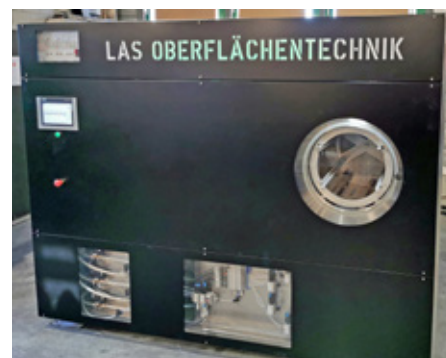
Die neue, selbst entwickelte Universal-Reinigungsanlage mit drei unterschiedlichen Bädern kann vollautomatisch Ultraschallreinigen, Spritzen, Spülen und Trocknen. Bild: Klaus Vollrath
