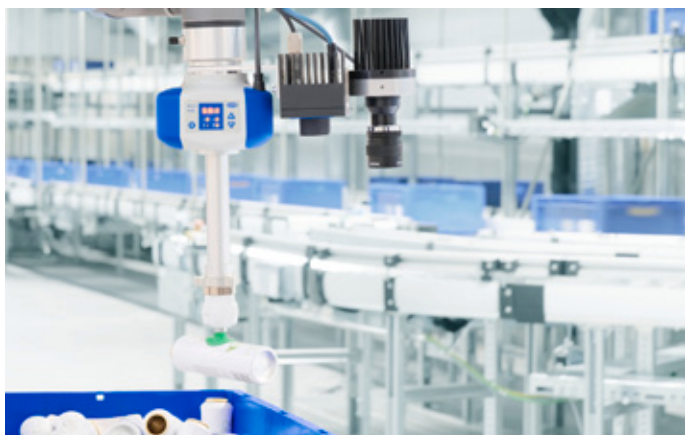
Das Vision- und Handling-Set 3D-R von Schmalz erleichtert den Einstieg in Bin-Picking-Anwendungen deutlich: Das integrierte Komplettsystem ist ohne grössere Vorkenntnisse in wenigen Stunden installiert.
