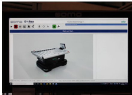
Das System übermittelt automatisch Arbeitsanweisungen oder den Status eines AGVs an die entsprechenden Montageplätze. Bilder: WILO SE
