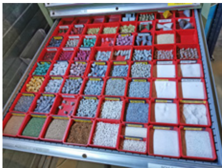
Das umfangreiche Lager an Betriebsmitteln für das Schleifen und Strahlen ermöglicht die Durchführung von praktischen Versuchen.
