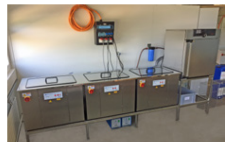
Lösung: Eine Kombination aus zwei Ultra- schallbädern und einem Spülbecken sowie einem Trockenschrank auf eigens hergestell- ten Unterstellen. Bild: LAS-Oberflächentechnik
