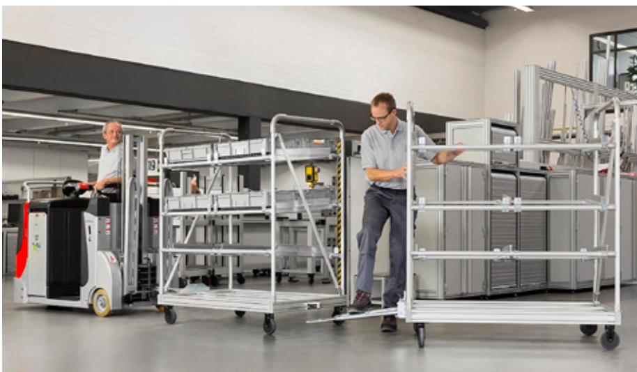
Zusätzlich zu verschiedenen Bock- und Lenkrollen, dem Staplerschuh, der Stapelführung, sowie dem Leit- und Eckschutz bietet item unterschiedliche Ausführungen von Deichseln an, mit denen Routenzugwagen optimal untereinander sowie mit dem Zugfahrzeug verbunden werden können. Bild: item
