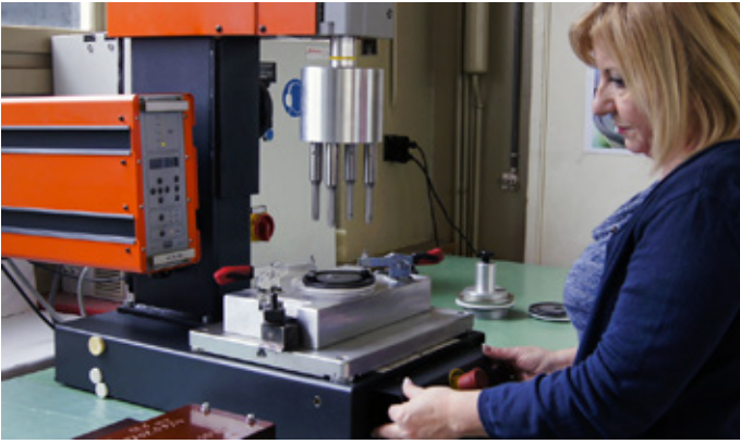
Nachbearbeitung, hier Ultraschallschweissen
