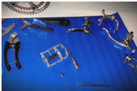
Die Rutsch-Stopp-Folie von Kager bewährt sich sowohl in der Montage- und Prüftechnik als auch bei feinwerk- und labortechnischen Tätigkeiten als ergonomischer Ersatz für platzraubende Fixier- und Klemmvorrichtungen. Bild: Kager
