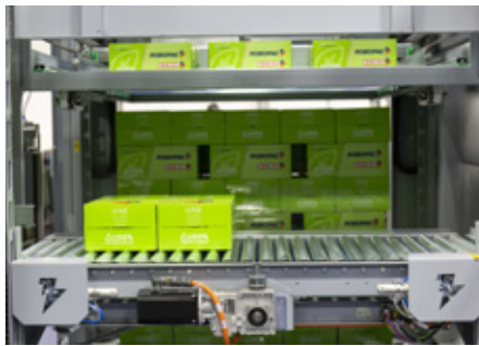
Die Waren wie Kartons, Dosen oder Kisten werden der Anlage über ein Förderband zugeführt. Die gewünschte Anordnung und Anzahl der Schichten lassen sich einfach über die integrierte Software festlegen. Bild: Aetnagroup S.p.A
