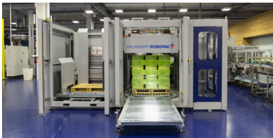
Die Anlage palettisiert Waren selbständig und foliert sie anschliessend ein. Durch die kompakte Konstruktion hat der Palwrapp auch in beengten Unternehmen Platz. Bild: Aetnagroup S.p.A
