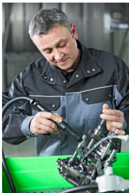
Der Pinselwaschtisch MEWA Bio-Circle sorgt in Werkstätten und Produktionsanlagen für eine umweltschonende Reinigung von Werkzeugen und Metallteilen. Die Reinigungsflüssigkeit auf wässriger Basis enthält natürliche Mikroorganismen und schützt Haut und Umwelt. Bild: MEWA
