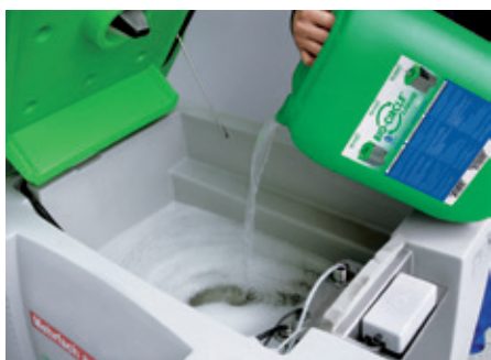
Der Pinselwaschtisch MEWA Bio-Circle sorgt in Werkstätten und Produktionsanlagen für eine umweltschonende Reinigung von Werkzeugen und Metallteilen. Die Reinigungsflüssigkeit auf wässriger Basis enthält natürliche Mikroorganismen und schützt Haut und Umwelt. Bild: MEWA
