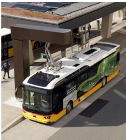
Die Postauto AG lädt ihr neues Scania-Elektropostauto mithilfe eines Pantographen. Bild: Postauto AG
