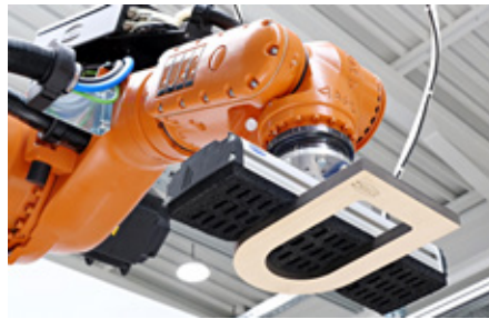
Der Alleskönner: Der Universalgreifer FXP-i/FMP-i kann jetzt über eine IO-Link-Schnittstelle Daten übertragen und wird damit vollwertiges Mitglied in der vernetzten Produktion. Bild: J. Schmalz GmbH
