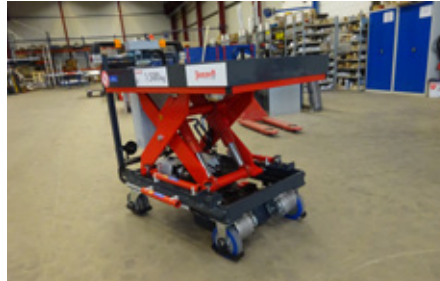
Das ErgoMove von Blicke bietet eine elektrische Antriebs-, Brems- und Lenkunterstützung für Lasten bis 2000 Kilogramm. Bild: Janzen Lifttechnik GmbH
