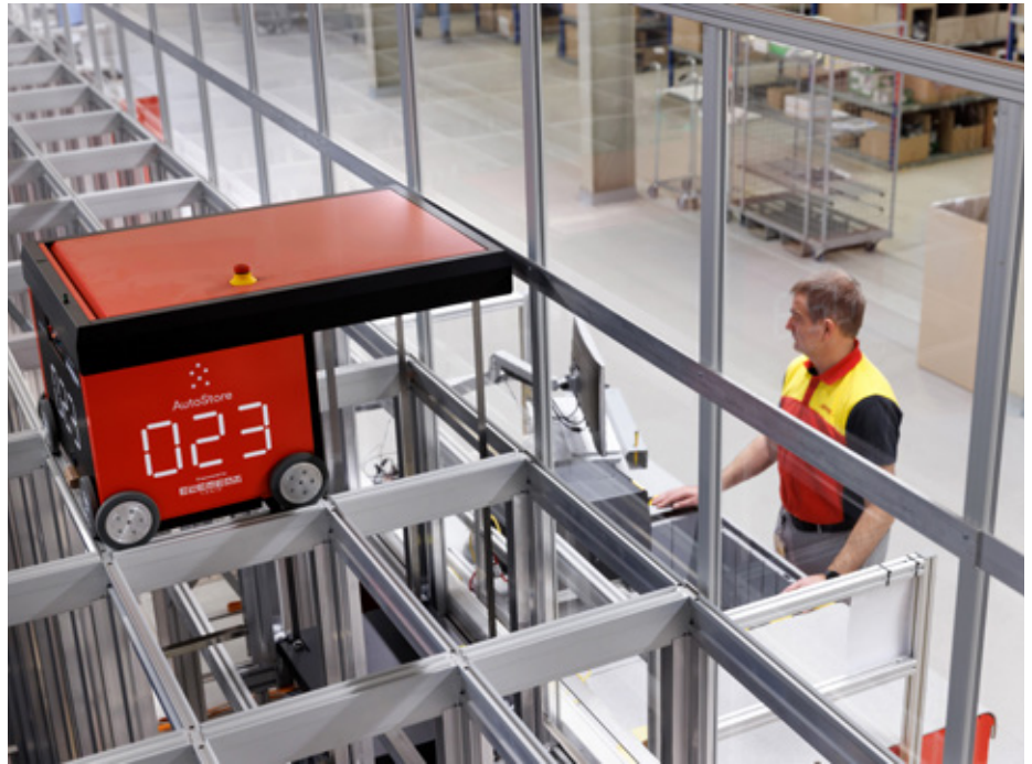
Dieses kompakte Lager- und Bereitstellungssystem ermöglicht eine extrem platzsparende Kleinteilelagerung und vollautomatische Kommissionierung von jährlich bis zu 18 Millionen Warenstücken. Bild: DHL
