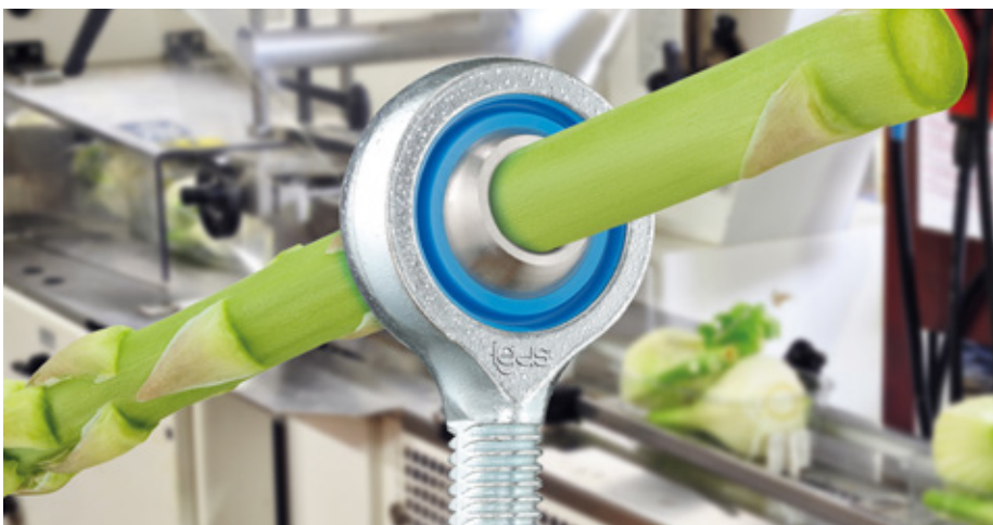
Der schmier- und wartungsfreie igubal Gelenkkopf für höher belastete Anwendungen in der Lebensmittelindustrie besteht aus einem Gehäuse und einer Kugelkalotte aus Edelstahl sowie einem Innenring aus dem FDA- und EU 10/2011-konformen Hochleistungskunststoff iglidur A160. Bild: igus GmbH
