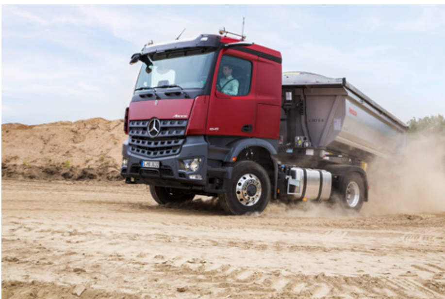
Mercedes-Benz Arocs 1845 LS 4x2, Exterieur, OM 471 Euro VI mit 330 kW (449 PS), 12,8 L Hubraum und 12-Gang Mercedes PowerShift 3. Bild: Daimler
